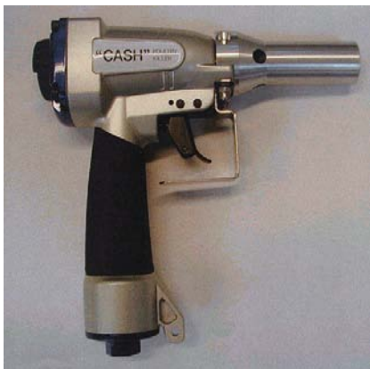
Abb. 4: Beispiel für ein Schuss-Schlag-Betäubungsgerät (stumpfer Bolzen, Druckluft getrieben).
